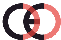
Falsk CE-mærke (for tæt på hinanden)
